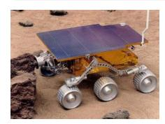
La NASA a choisi plusieurs fois l'option des panneaux solaires pour fournir l'énergie nécessaire au bon fonctionnement de ses sondes et rovers sur la planète Mars. On peut citer par exemple le petit robot Sojourner, pionnier des rovers sur le sol martien en 1997, qui était équipé d'un petit panneau solaire d'une surface de 0,25m².
