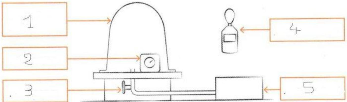
Associez le numéro inscrit sur le schéma aux mots proposés : pompe, cloche à vide, soupape, buzzer, sonomètre.
